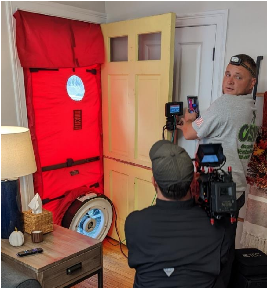
Blower Door Test – See appendix slides
